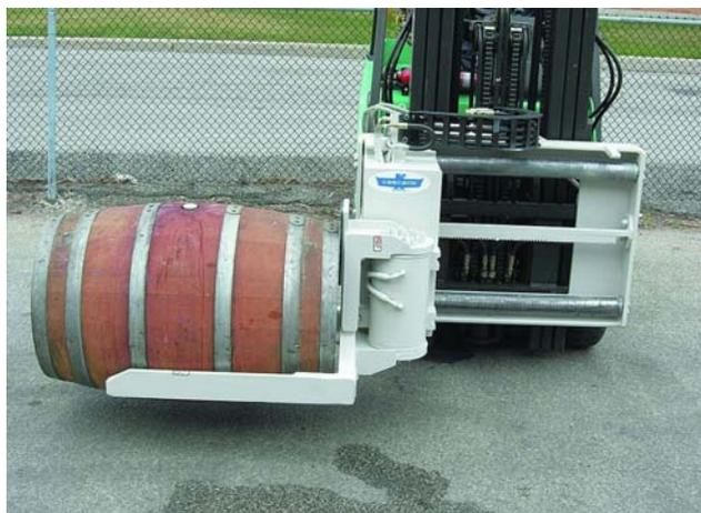
Pinza per la movimentazione con l'ausilio del carrello elevatore delle botti con il vino.
